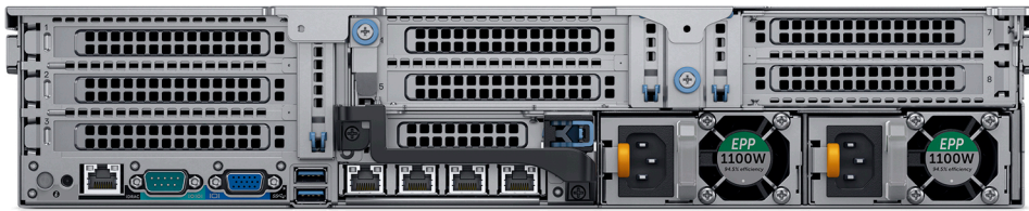
R740 - Vista posteriore: con 4 slot PCIe disponibili con protezioni scheda riser 2 e scheda riser 3
